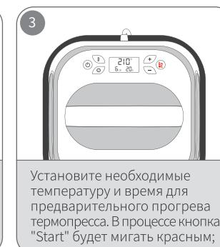
Установите необходимые температуру и время для предварительного прогрева термопресса. В процессе кнопка "Start" будет мигать красным;
