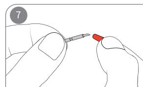
Выньте держатель ножа и лезвие. Снимите защитный колпачок с лезвия.
