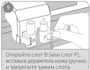
Откройте слот B (или слот P), вставьте держатель ножа (ручки) и закрепите зажим слота.
