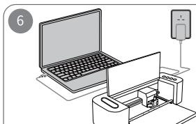
Подключите плоттер к компьютеру с помощью USB кабеля или Bluetooth;
